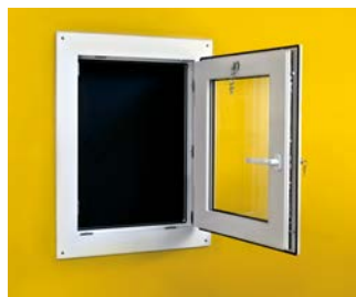
Integriertes gasdichtes ULO-Fenster. Spezialanfertigung mit Schlüsselschließung und 1-Hebel-Bedienung für den Notausstieg. Drehbeschlag mit 10-Punkt-Verriegelung.
